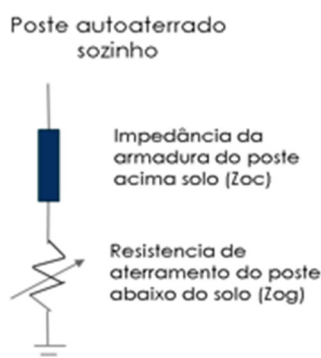
Figura 7 – Impedância de aterramento – Poste Autoaterrado
